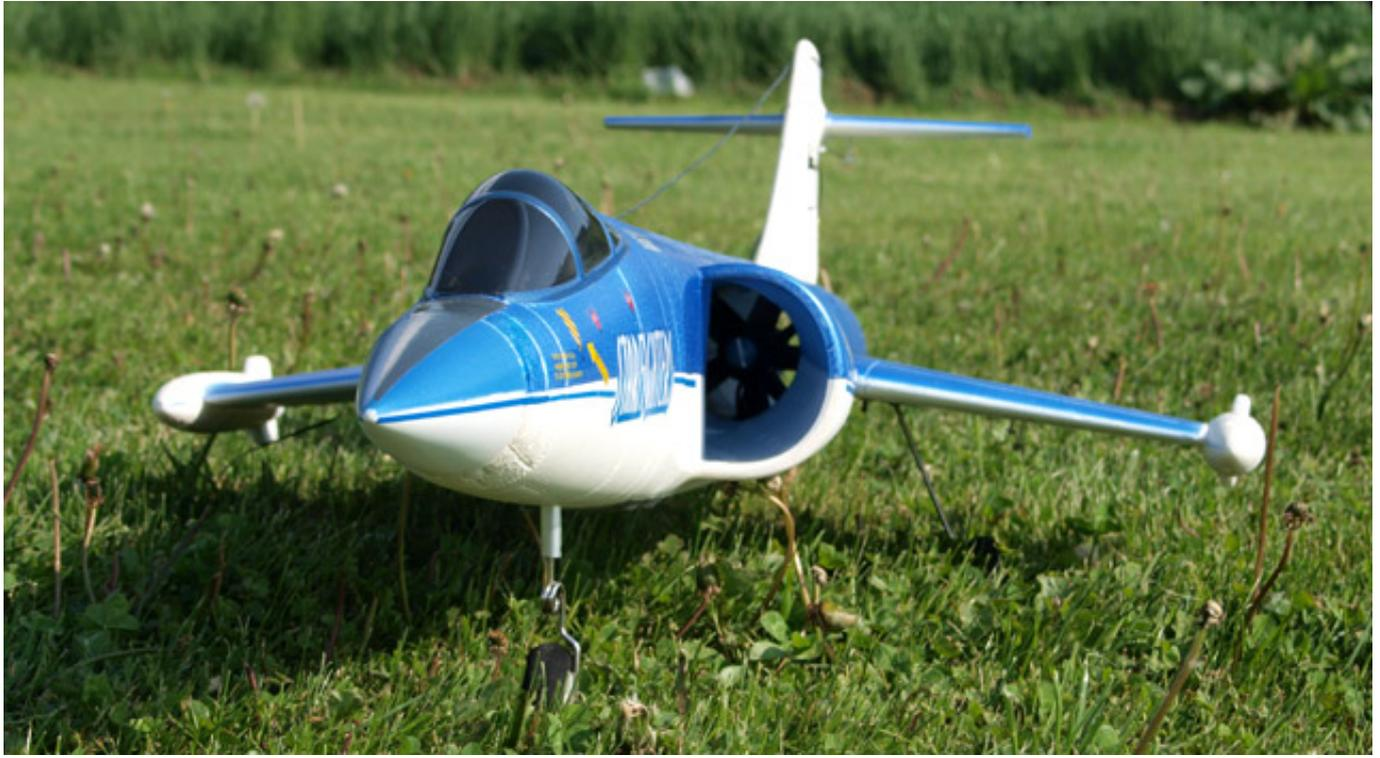
Probleme gab es beim Zusammenbau eigentlich nur eines, nämlich ein Servo, in dem Kleber bei der Produktion hingelaufen war. Es ließ sich aber reparieren. Man sollte also unbedingt vor dem Zusammenbauen die Servos testen.
