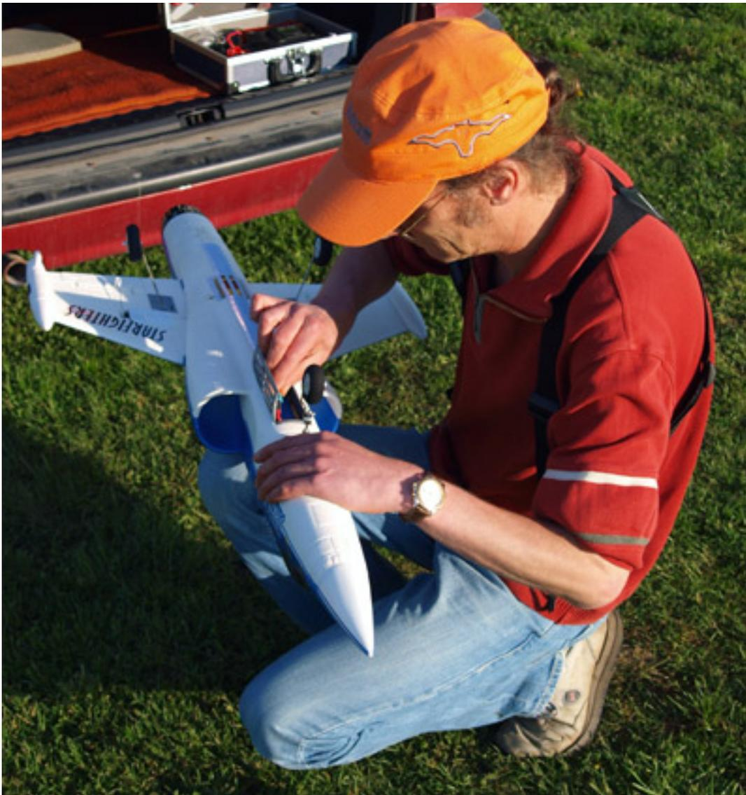
Der Regler sitzt "luftig" in der Rumpfmittle und damit ist für ausreichende Kühlung gesorgt. Die Wartungsklappe an der Unterseite, unter der der Impeller montiert ist, lässt sich leider nicht beschädigungsfrei öffnen, da sie bei der Montage mit dem
