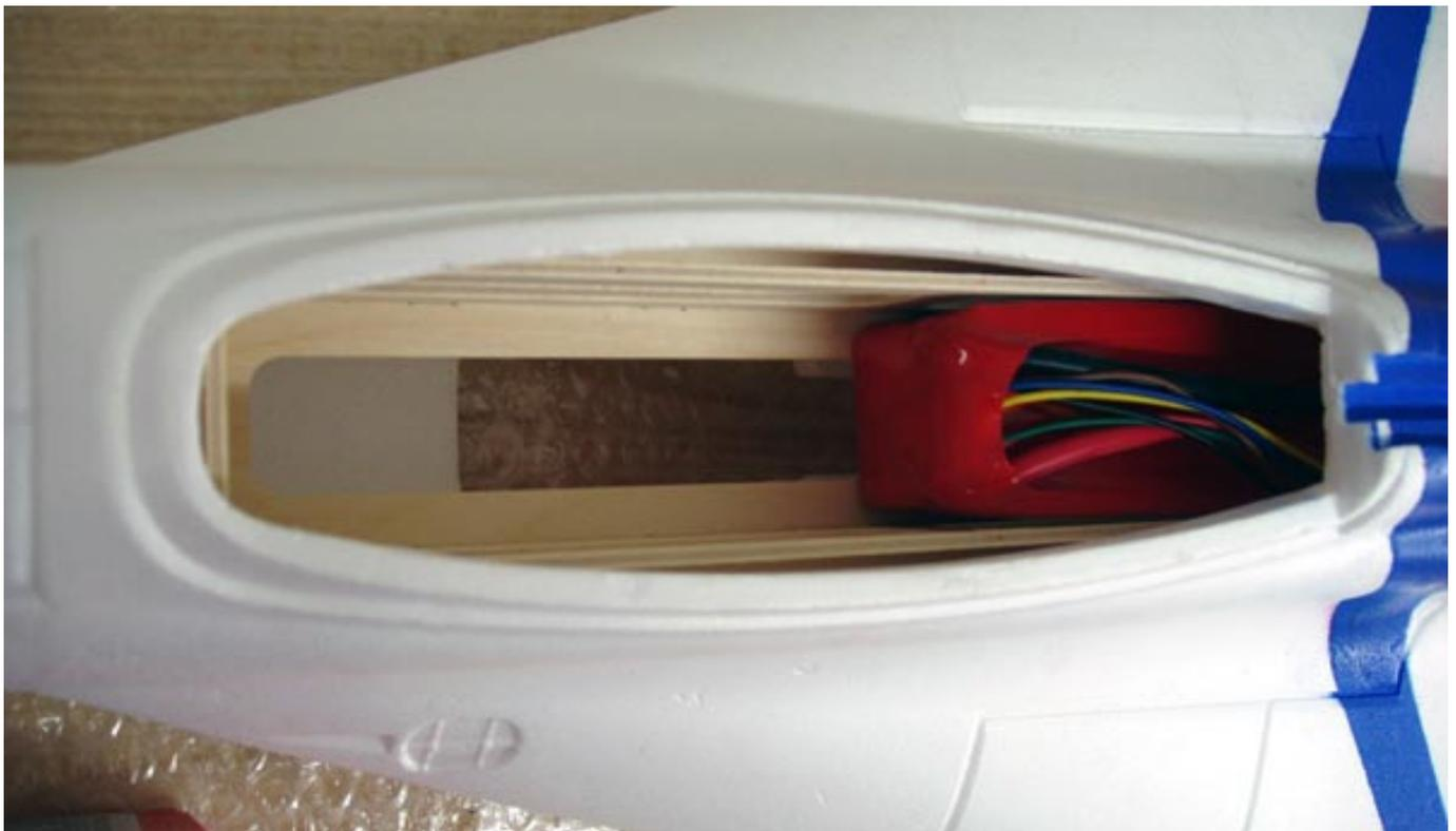
Die Akkus lassen sich nach Abnehmen der Haube einfach wechseln. Es ist aber schon ganz schön eng unter dem Cockpit. Gehalten werden die beiden Akkus von je einem Klettband, welches um die Akkuaufnahme herumgeführt ist.
