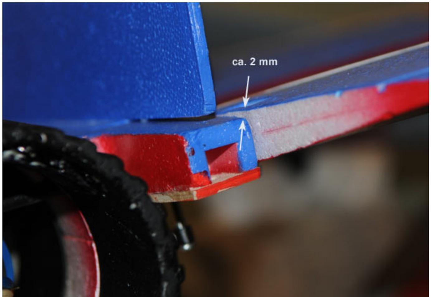
Man sieht, dass die Tailerons gemessen am Rumpfende ca. zwei Millimeter höher stehen. Für die Landung mit deutlichem Gegenwind habe ich eine Landephase programmiert bei dem der Offset null beträgt und so der Flieger dann sinkt. Zum Start habe ich eine Flugphase angelegt bei dem der Offset sechs Millimeter beträgt.
