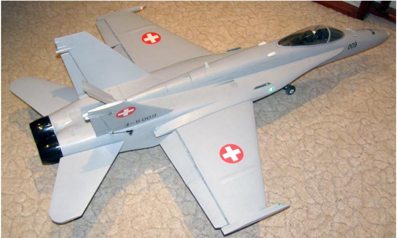
Das Laminieren war der nächste Bauabschnitt. Dazu wurde die F18 komplett gespachtelt und geschliffen. Das Spachteln erfolgte mit Molto-Leichtspachtel für Styro. Die Hornet wurde mit 25-g-Matte und 24 Stunden-Epoxy bezogen und danach nochmals mehrfach gespachtelt und geschliffen. Es zeigte sich, dass 48-g-Matte die bessere Wahl gewesen wäre. Grund ist ein geringerer Harzbedarf und eine noch bessere Haltbarkeit.
