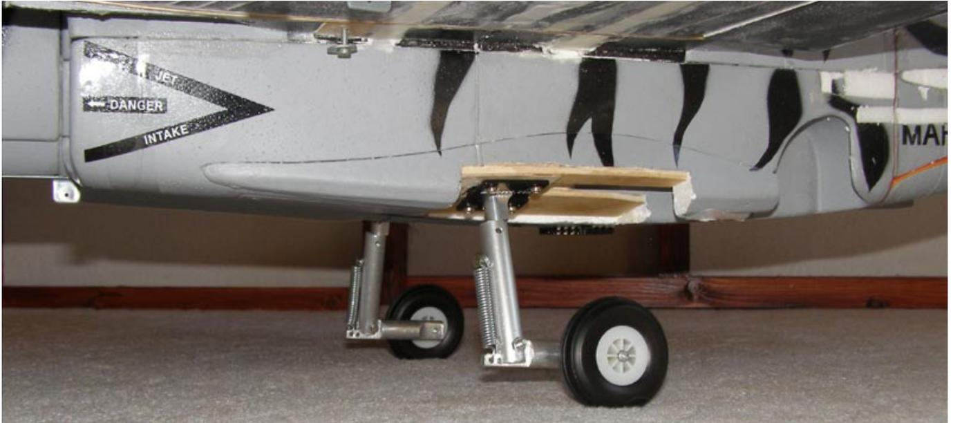
Nach der Verstärkung wurden die Luftschläuche verlegt und die hintere und die vordere Rumpfsektion verklebt.
