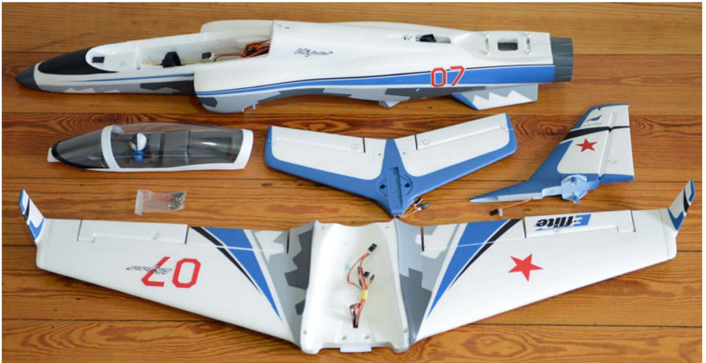
Das ganze Modell besteht im Wesentlichen aus lediglich fünf Komponenten und zwar Rumpf mit Seitenleitwerk, Cockpit mit Pilot, dem nicht geteilten Flügel sowie dem Höhenleitwerk und dem Seitenleitwerk. Alle Servos sowie das elektrische Einziehfahrwerk sind bereits eingebaut und die Anlenkungen sind ebenfalls schon vormontiert.
