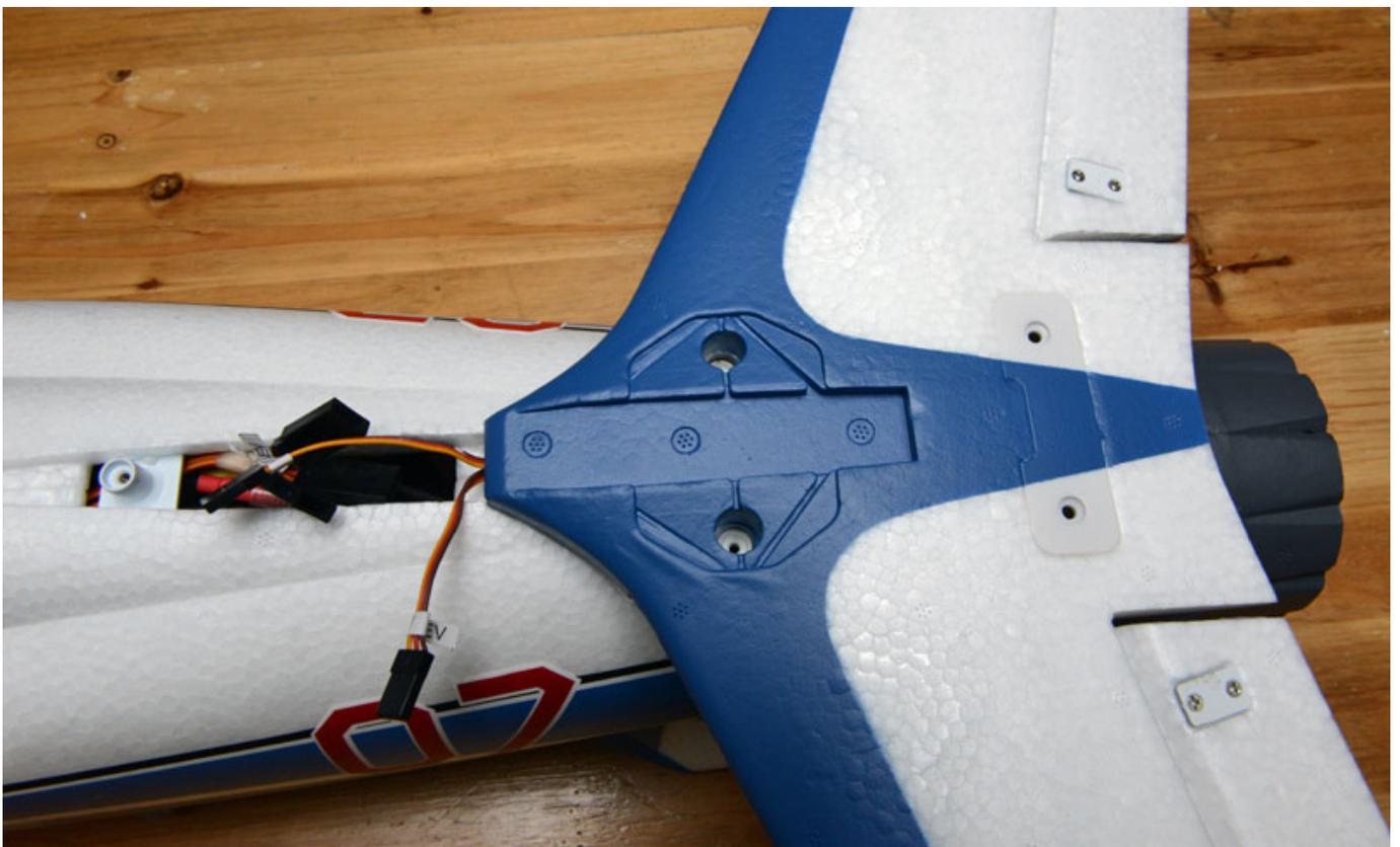
Als nächstes wird das Seitenleitwerk (s. Abb. unten) montiert. Hierzu muss ebenfalls zunächst das Servokabel angeschlossen werden und dann steckt man das Seitenleitwerk auf das Höhenleitwerk.
