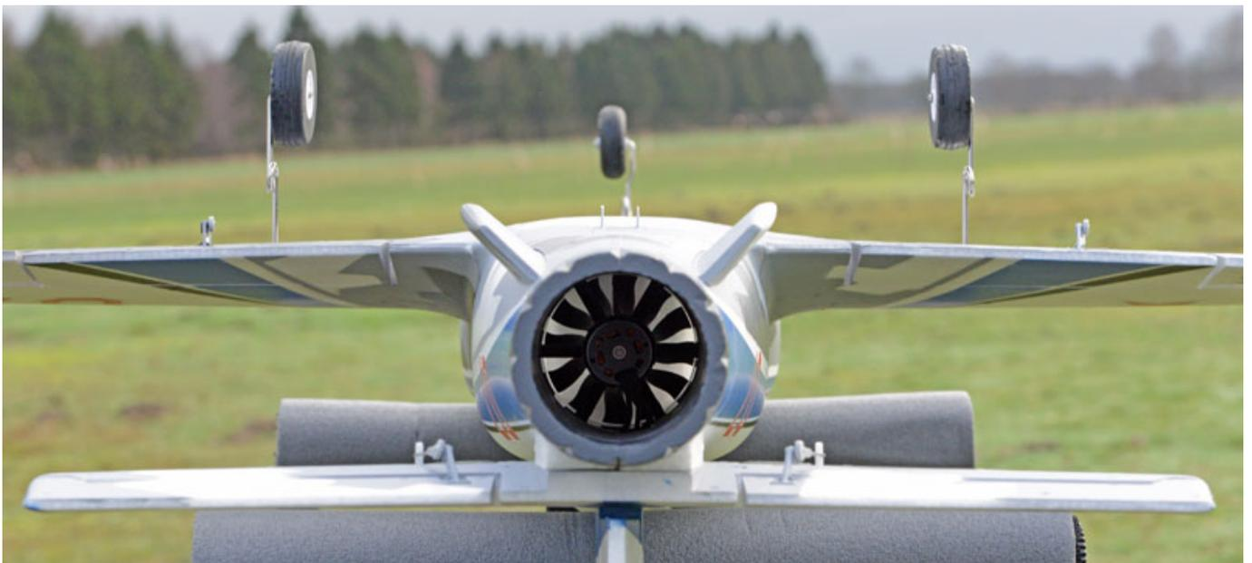
Beim Test am Boden vor dem Erstflug haben wir einen Maximalstandsdruck von 1,8 kp gemessen und das bei einem Strom von 72 Ampere. Nach 20 Sekunden Laufzeit betrug der Strom 66 Ampere bei 1,6 kp Standsdruck. Mit unserem 3.600 mAh Akkubetrag das Abfluggewicht exakt 2,00 kg. Das ergibt ein
