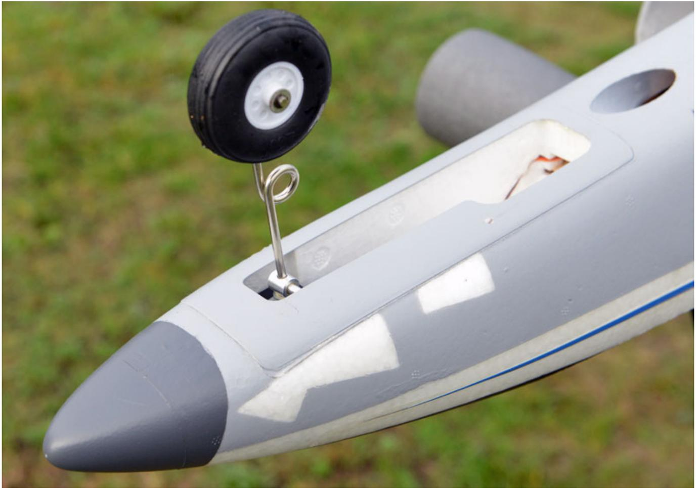
Das vordere Fahrwerk ist ja auf einem Kanal mit dem Seitenruder: Es lässt sich vorne durch Lösen einer Schraube auf Geradeauslauf ausrichten.
