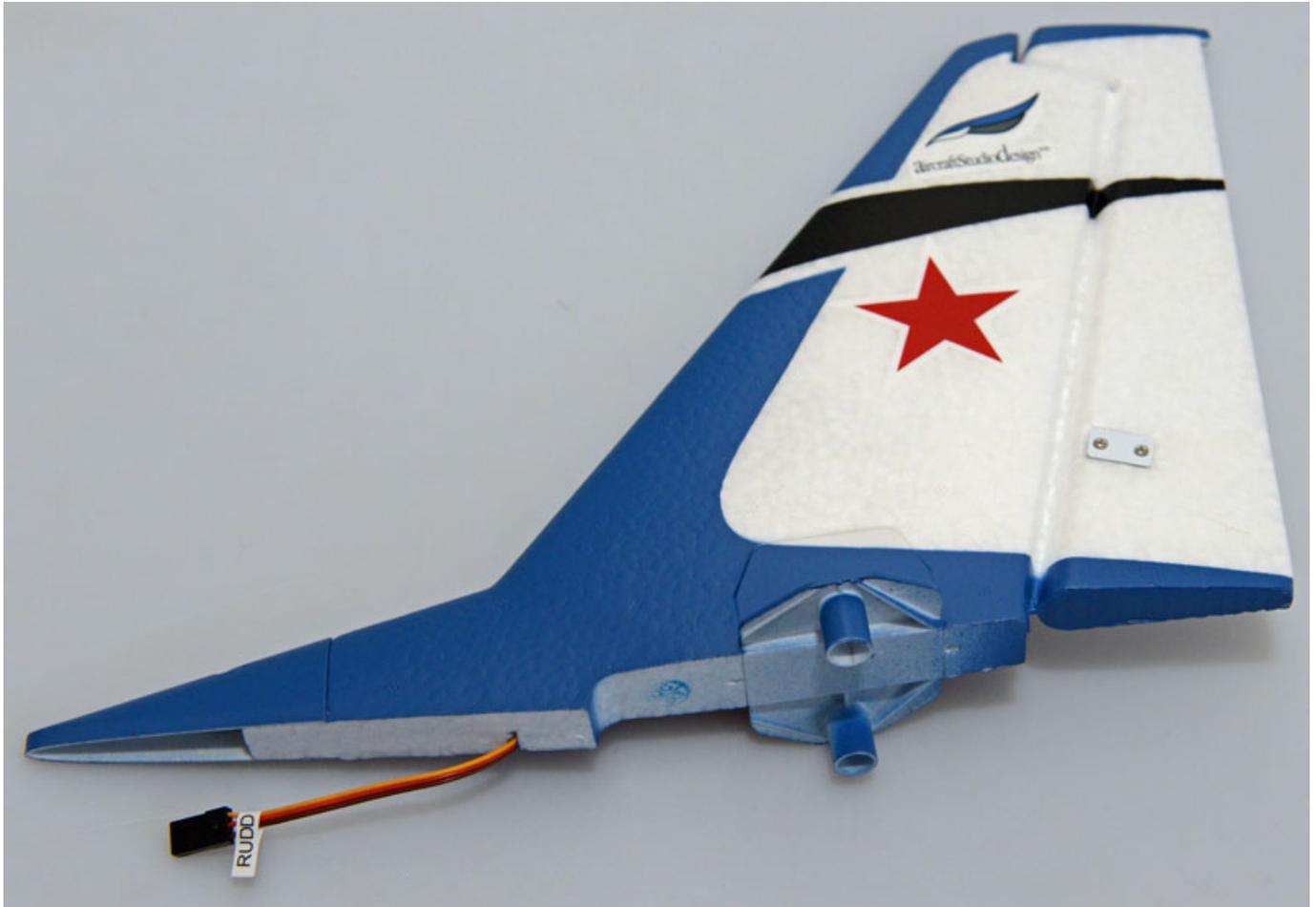
Nun werden die drei Schrauben für das Seitenleitwerk eingeschraubt aber nur soweit anziehen bis leichter Widerstand spürbar ist. Dann die hinteren beiden Schrauben soweit festziehen das die Plastikteile eben mit dem Höhenleitwerk sind. Nun die vorderen und dann nochmal die hinteren festziehen aber dabei nicht überdrehen.
