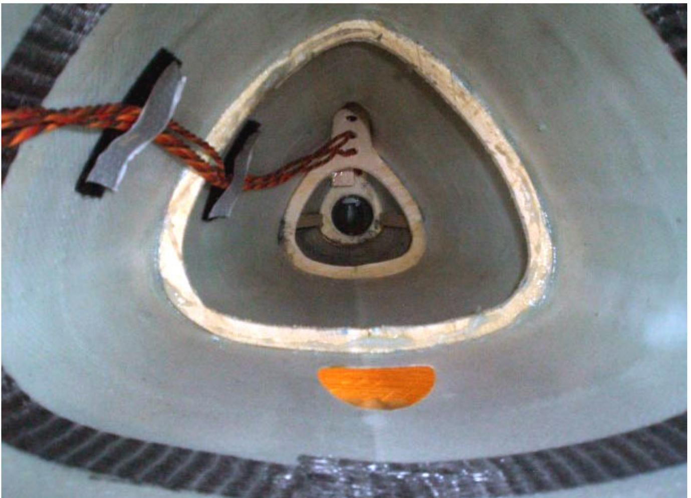
Die abnehmbaren Triebwerksgondeln sind für den denn Einbau von 90-mm-Impeller ausgelegt. Sascha entschied sich für zwei WeMoTec Midi Fan Pro.
