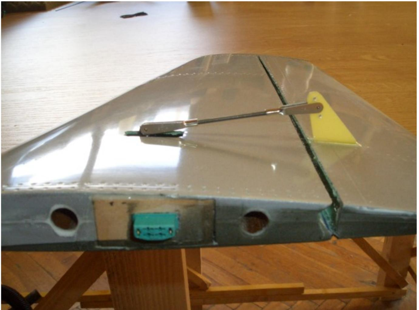
Hier die Steckung des Höhenruder (Bild unten) und der MPX-Stecker für die Servo-Steckverbindung, wie auch in den Flügelhäften für die Querruder (s. oben).
