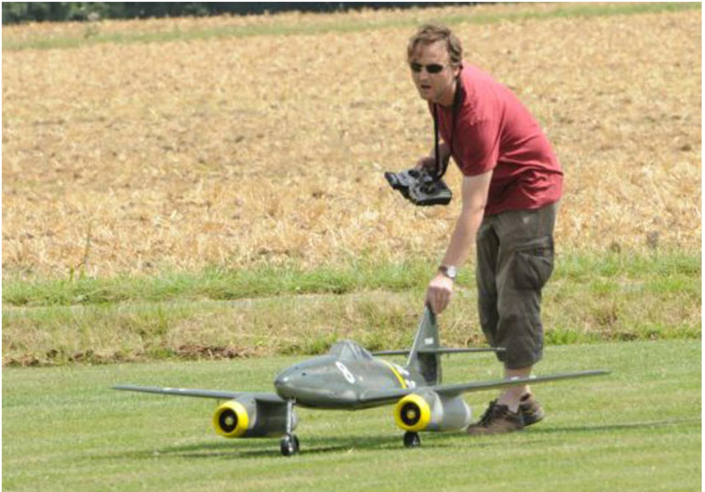
Nach dem Abheben etwas Höhe nachlassen, um das gefürchtete Stallen zu verhindern. Die Triebwerke unterhalb der Flugzeuglängsachse bewirken ein aufrichtendes Moment und dies kann bei zu langsamer Geschwindigkeit und damit verbundener zu geringer Höhenruderwirkung, dann zum Stallen führen. Sascha konnte dies aber nie beobachtet - hat es aber auch nie provoziert. Nach weiterer Fahrtaufnahme kann der Pilot, wenn er von Scale-Fliegen nicht hält, das Modell erstmal senkrecht steigen lassen.
