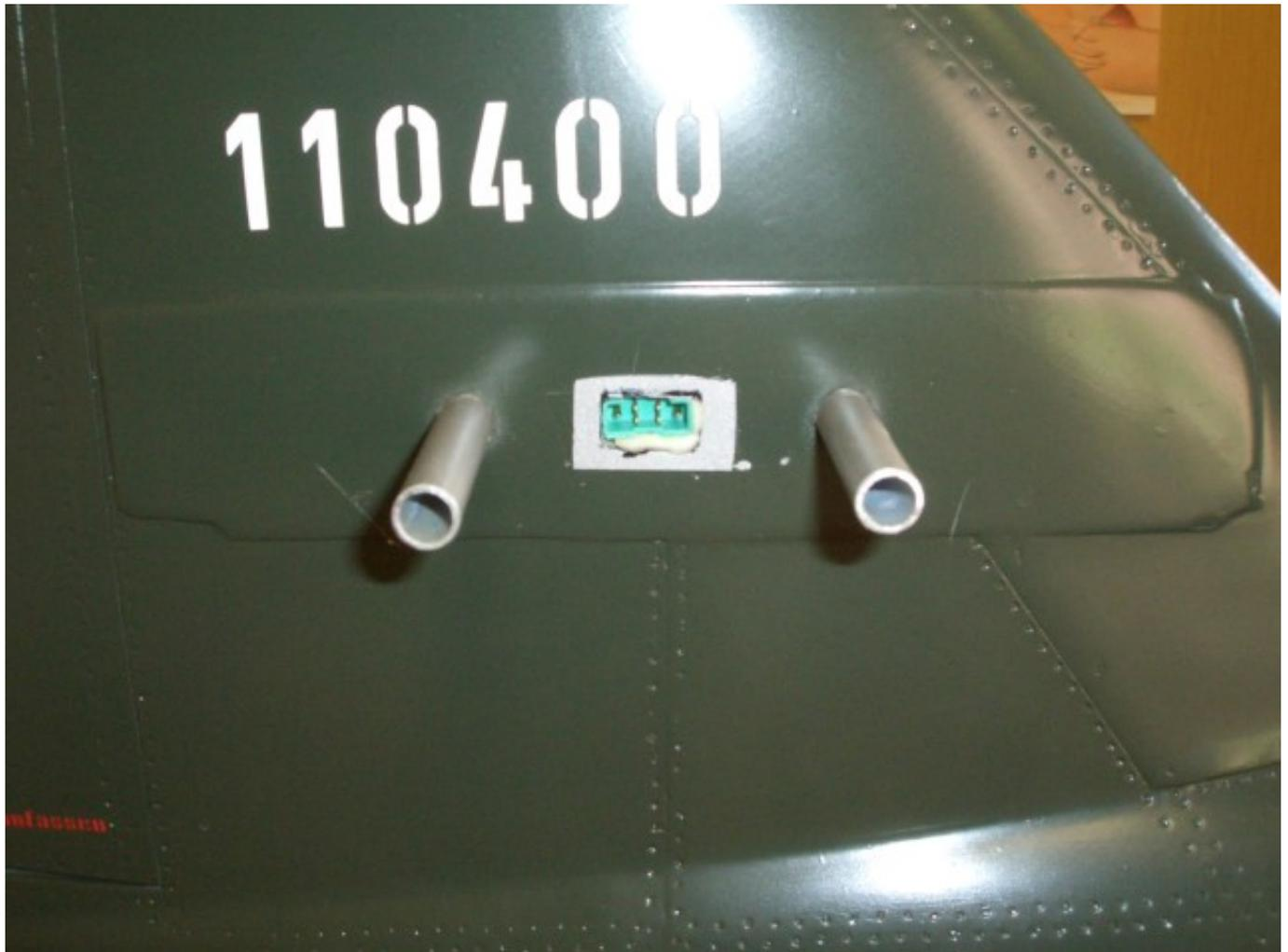
Die vordere Luke am Rumpf zum Bestücken mit Akkus nach Wahl links und rechts der Fahrwerksaufnahme auf den Brettchen mit Klettband. Bei Sascha sind das 2 x 5 S 5800er Lipos, welche in Reihe als 10 S beide Motoren versorgen. Insgesamt fließen so maximal 118 A. Rechts befindet sich das Lenkservo (13-mm-Metallgetriebeklasse) und links das Einziehfahrwerksservo D9500.
