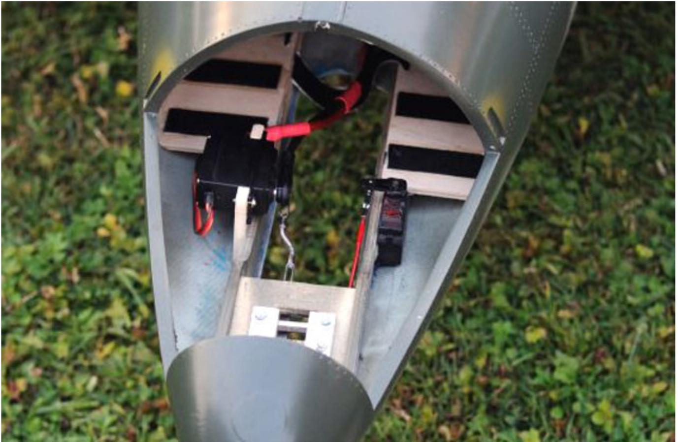
Bei den Fahrwerken handelt es sich um Mechaniken und Telebeine von Gerhard Kenner ([www.einziehfahrwerk.de](http://www.einziehfahrwerk.de)) speziell für die Airworld Me 262. Der Preis des genutzten Fahrwerks beläuft sich auf ca. 300 Euro. Die Räder auf den Hauptfahrwerksbeinen sind Kavan-Luftreifen mit einem Durchmesser von 100 mm. Vorne rollt ein Graupner-Leichttrad mit 85 mm Durchmesser.
