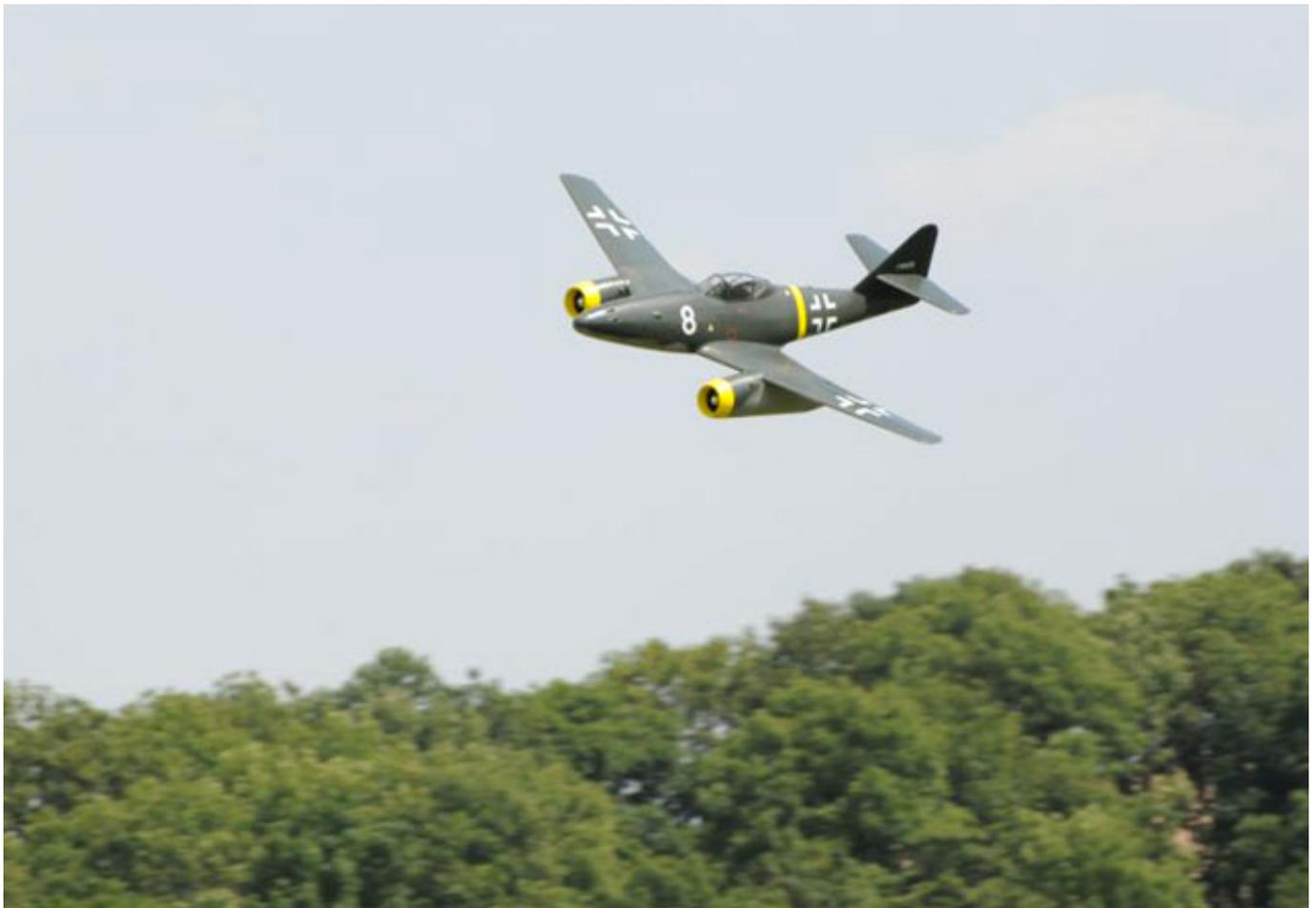
Zur Landung fährt Sascha die Querruder 15 mm nach oben. Dies vernichtet Auftrieb und schränkt die Fläche. Sie kann damit wirklich sehr langsam zuerst auf dem Hauptfahrwerk aufgesetzt werden. Der Landeanflug erfolgt flach und mit dem Gas wird der Sinkwinkel gesteuert.
